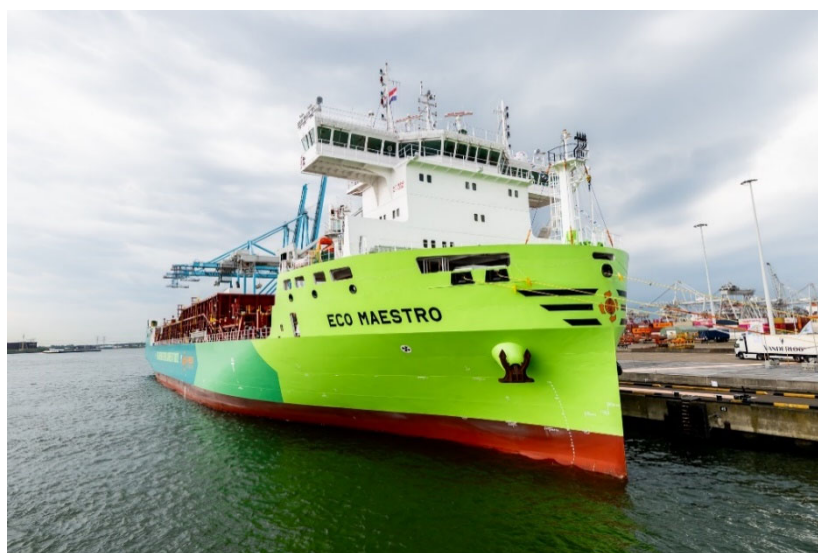
図 24 X Press Feeder 所有のメタノール二元燃料船 Eco Maestro
