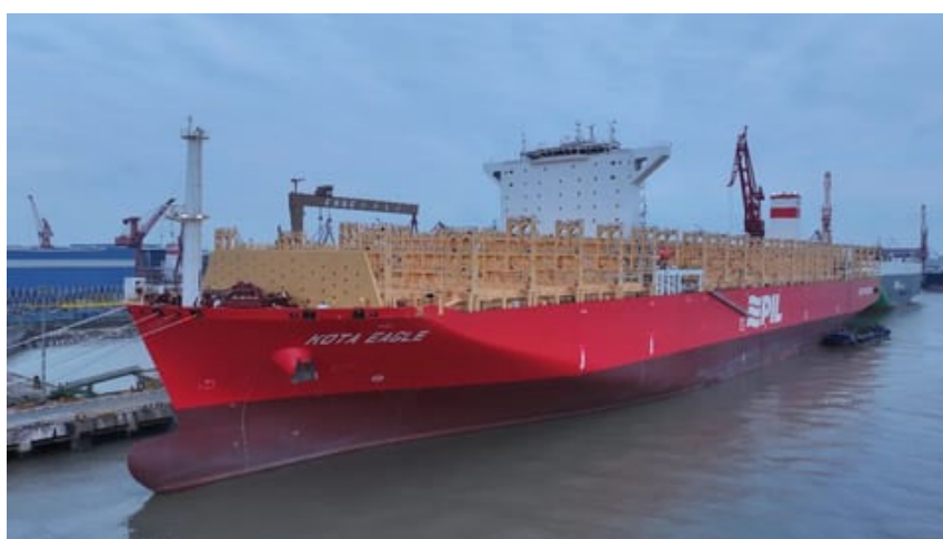
図 21 LNG 二元燃料コンテナ船「Kota Eagle」
