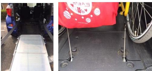
左:スロープを引き出したところ。引き込み用のベルトを車いすの背もたれに掛けて、介助者が押して登ります。途中で手を放しても、ベルトが巻き取られているので後ろへ下がることはありません。
