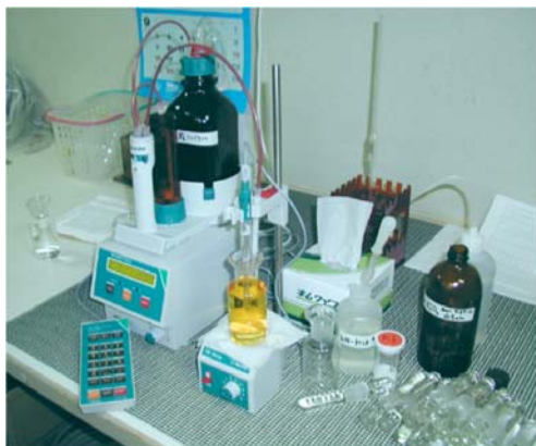
海水の酸素量(溶存酸素)を測定するための自動滴定計
