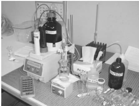
海水の酸素量(溶存酸素)を測定するための自動滴定計
