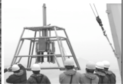
海底の堆積物を採取する装置
