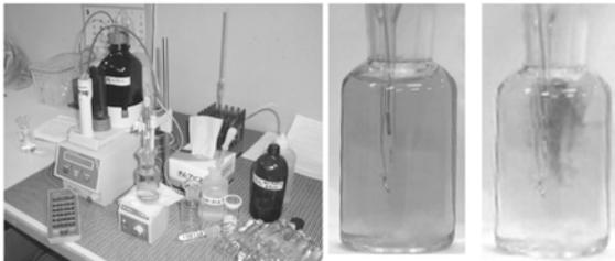
海水に溶けている酸素量を測定するための自動（終点を装置が自動的に判断する）滴定装置；左、人の目で終点を判断するときは、デンプン溶液を添加し青紫色にする
