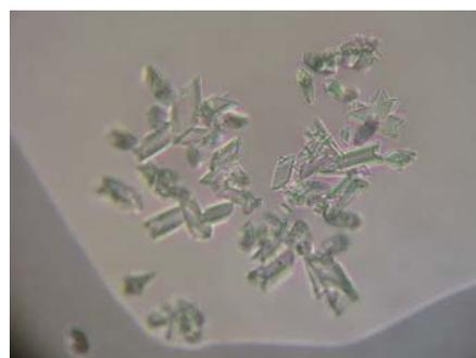
蒸発が進むにつれて濃度が高まり、結晶が安定して大きく成長するようになります。
