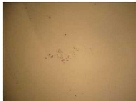
蒸発が進むにつれ、結晶が成長します。
