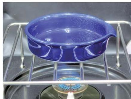
1分あまりが経過すると、蒸発皿の一部が写真のように干上がってきます。このような状態になれば、火力をさらに落とします。
