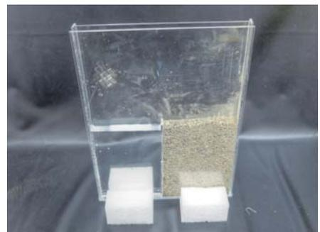
砂、水を入れた実験箱を、写真のように白熱球の真下に置きます。
