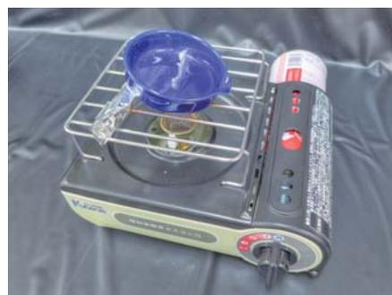
少しでも火力が強すぎると結晶が飛び散りますので、火力調節に注意しましょう。
