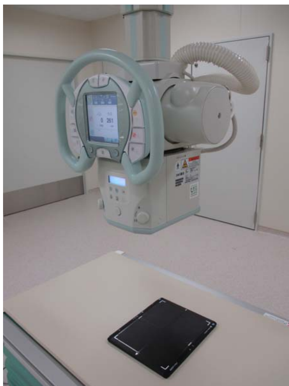
日向病院（宮崎県） X線撮影装置
