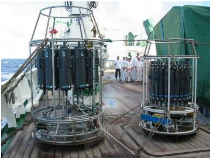
CTD: 表面から深いところまでの水温や塩分などを測りながら、海水を採集する機械
